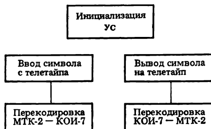
Рис. 6.4. Структура драйвера телетайпа
